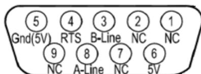
Abbildung 40 Klemmenbelegung Profibus
